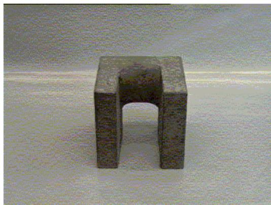
**Einzelner Hohlformkörper (Tunnel Cube) als Bauelement einer einlagigen Deckschicht**
