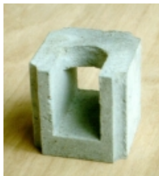
Abb.12: Hollow Cube (Tube Cube, Leitungskubus) ohne Verbundelemente jedoch mit Auskehlungen an den vertikalen Kanten.
