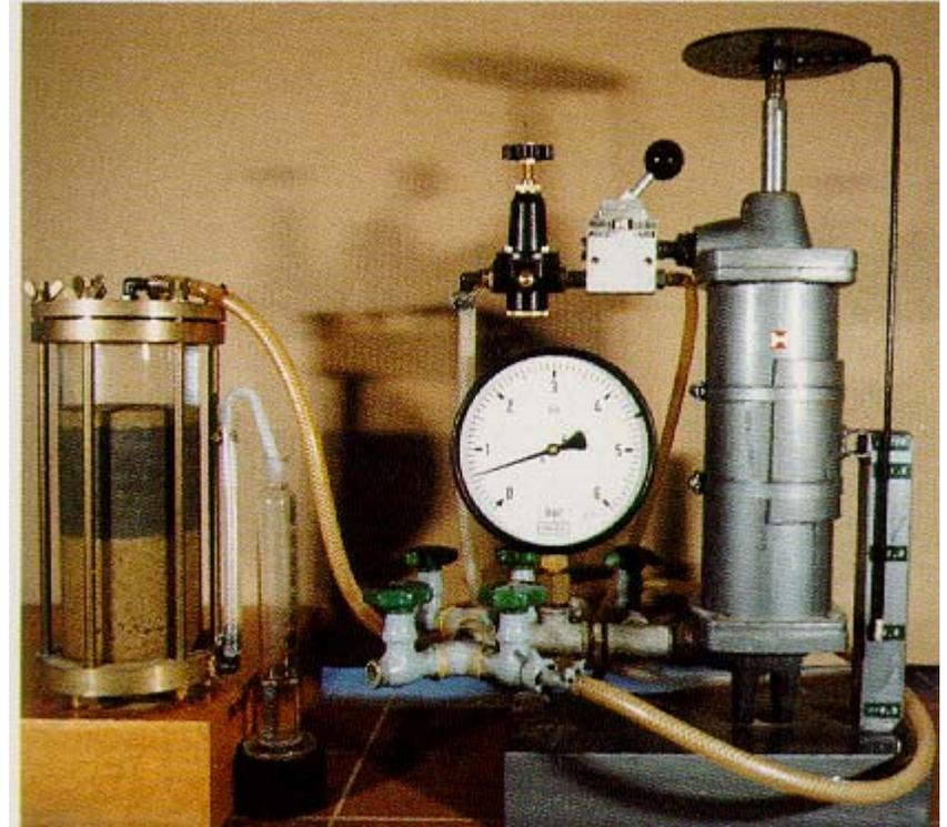
Die Untersuchung größerer Druckdifferenzen an Bodenproben erfolgt unter Verwendung einer Hydraulischen Presse.
