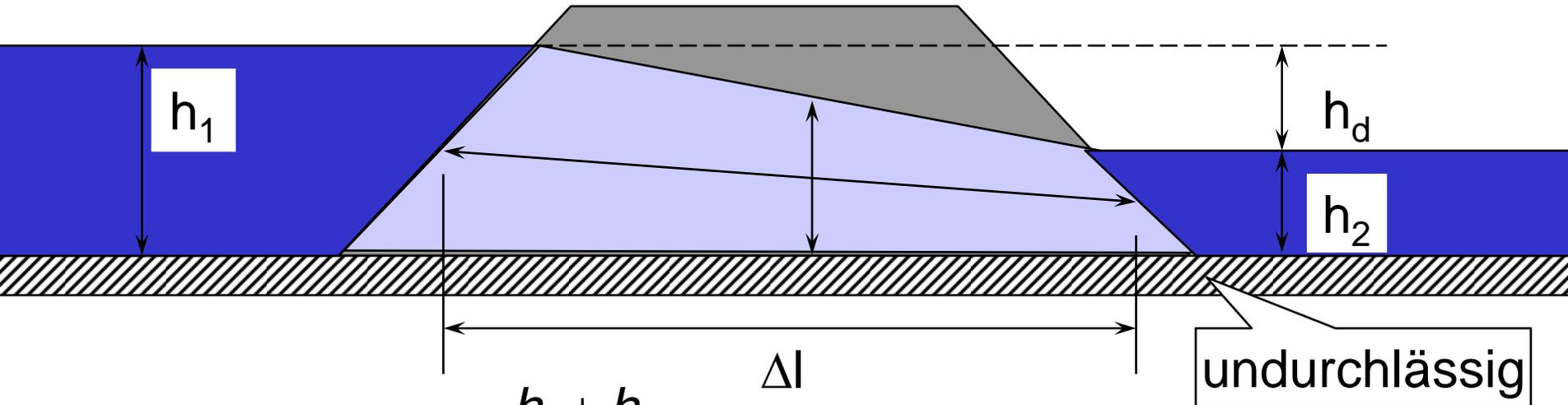
$$h_d = h_1 - h_2 \quad A_{GW} \approx \frac{h_1 + h_2}{2} \cdot L$$
