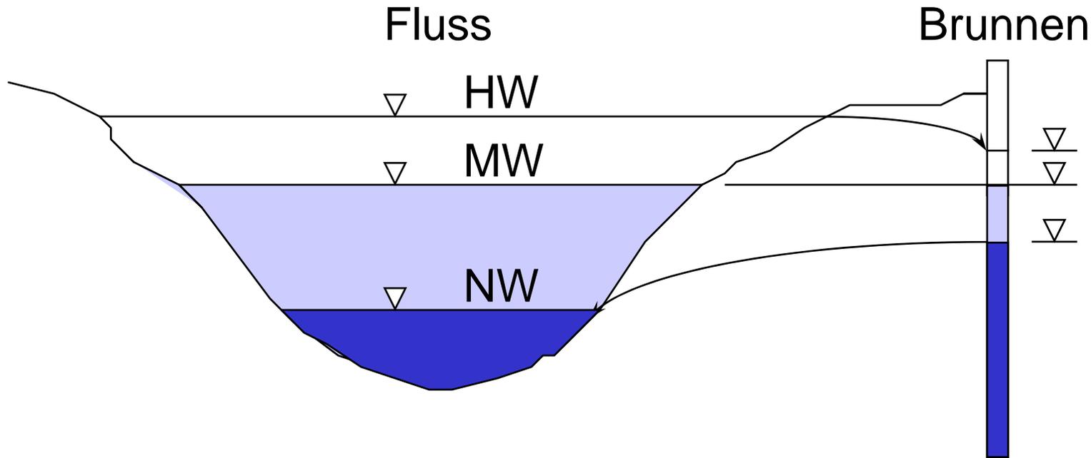
Bei lang anhaltendem HW-Abfluss besteht Tendenz der Sickerung in Richtung Brunnen (ggf. mit der Gefahr, dass Schadstoffe aus dem Fluss in Brunnen gelangen).
