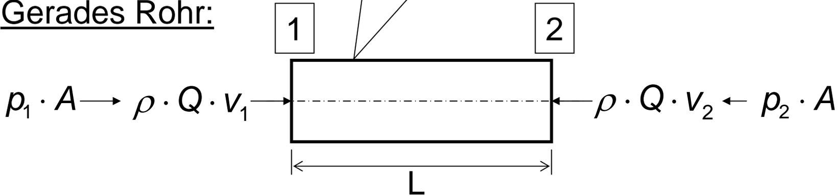
Bei *stationärer* Strömung  $Q$  durch *geradliniges* Rohrstück mit konstantem Querschnitt (= Kontrollvolumen) gibt es keine resultierende *Impulskraft*, da sich eintretender Impuls  $F_{J1}$  und austretender Impuls  $F_{J2}$  auf gleicher Wirkungslinie wegen  $v_1 = v_2$  aufheben. Wegen der Rohrreibung gibt es jedoch eine Differenz der beiden *Druckkräfte*  $F_1 - F_2 = p_1 \cdot A - p_2 \cdot A = (p_1 - p_2) \cdot A$ .
