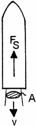
Ein austretender Strahl übt eine Kraft entgegen seiner Ausströmrichtung aus.
