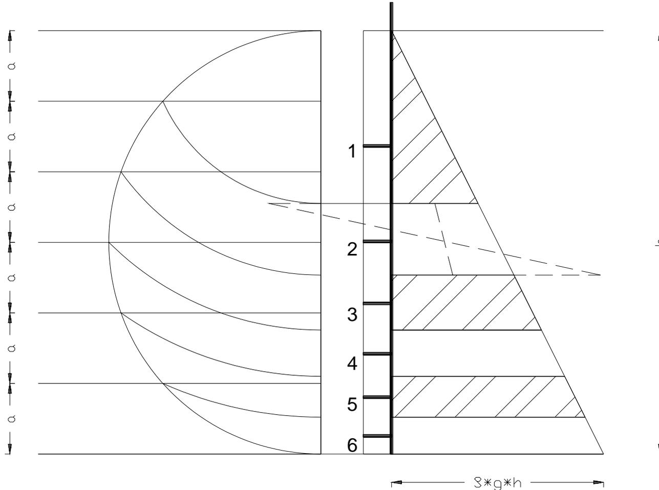
Gleiche Wasserlasten wirken auf 6 horizontalen Träger (Riegel)
