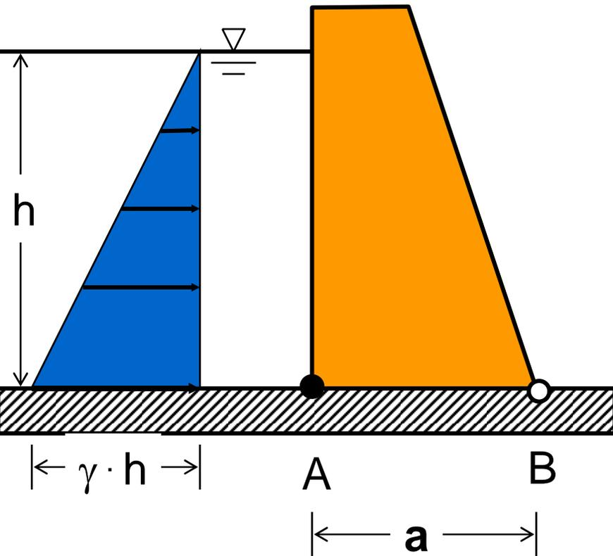
Die Wirkungslinie der aus der Druckspannungsfigur resultierenden Kraft verläuft durch den Schwerpunkt der Druckspannungsfigur.
