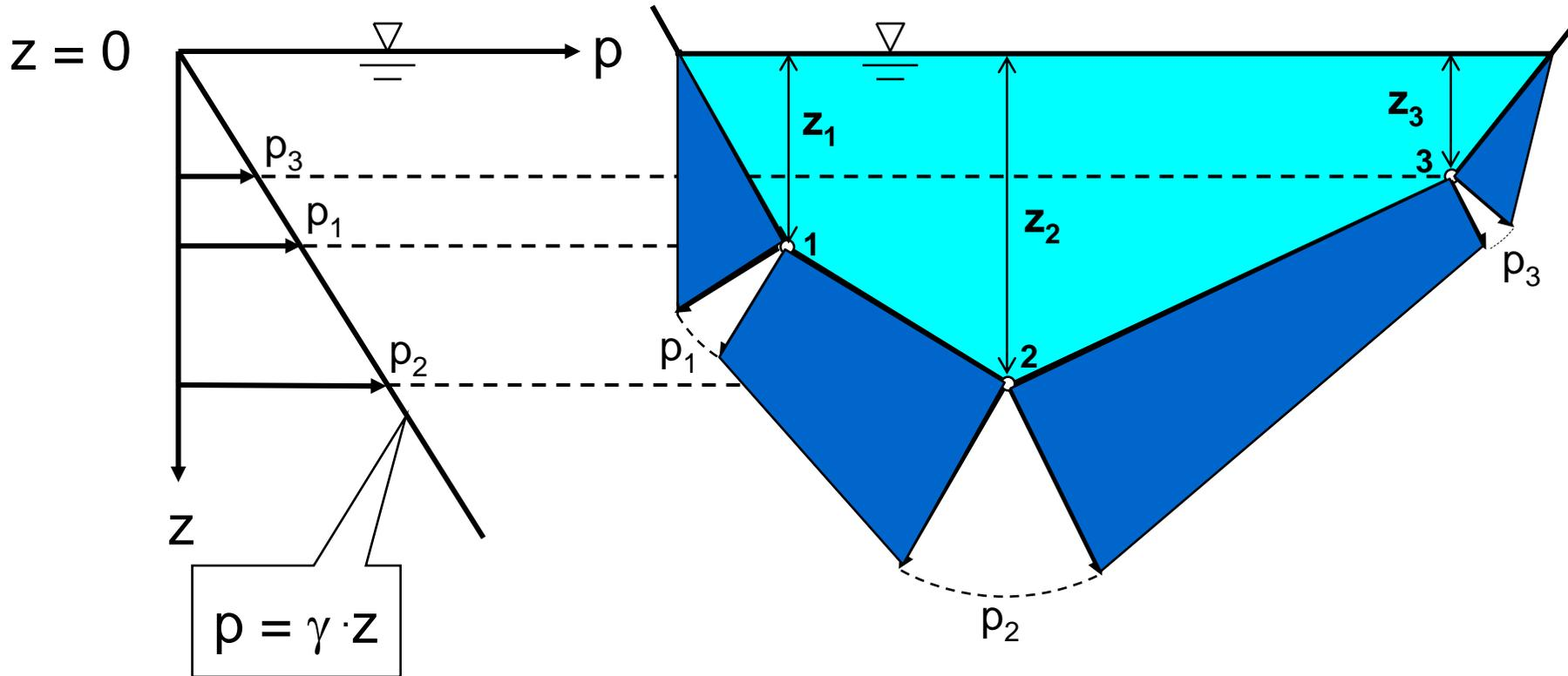
Die Druckspannung  $p$  wirkt stets *aus* der Flüssigkeit *senkrecht* auf das betrachtete Wandelement. Druckspannungsfiguren können an der Innenseite oder der Außenseite dargestellt werden.
