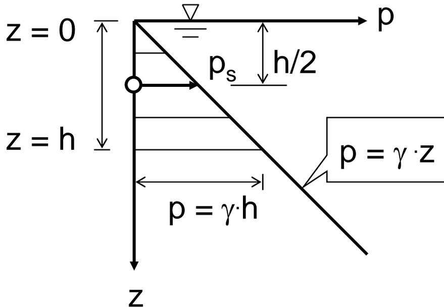
Die Integration der Druckspannungsverteilung  $p(z)$  in den Grenzen  $z = 0$  (Spiegel) bis  $z = h$  liefert zunächst die resultierende *Linienlast* [in kN/m]:
