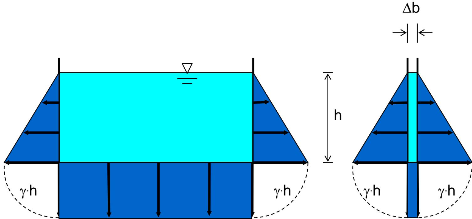
Unabhängig von der Breite (eines Behälters) ist die horizontale Druckverteilung gleich. Auch in engsten Fugen  $\Delta b$  und Klüften (Riss in der Bauwerksoberfläche) wirkt der *volle* Flüssigkeitsdruck.
