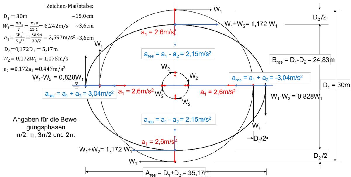
Abb.2: Graphische Ermittlung der elliptischen Orbitalbahnen in der Normallage mit horizontaler Hauptachse. Vektoraddition für das Verhältnis  $D_1/D_2 = 30\text{m}/5,17\text{m} = 5,8/1$ . Dasselbe Verhältnis gilt auch für die Beträge der Umfangsgeschwindigkeiten  $W_1 = 5,8W_2$  und der Umfangsbeschleunigungen  $a_1 = 5,8a_2$ .
